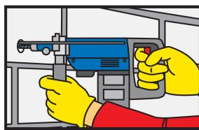
Пробурите отверстие необходимой глубины и диаметра при помощи перфоратора. Диаметр отверстия должен соответствовать размеру крепёжного элемента.
