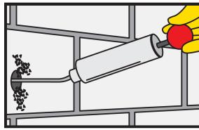
Продуйте отверстия с помощью ручного насоса или компрессора не менее двух раз. Продувку необходимо выполнять со дна отверстия! Важно: использовать безмасляные компрессоры.
