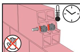
Во время отверждения анкеровочного состава не допускается перемещать или нагружать крепление. Инструменты следует очистить сразу после использования при помощи Sika® Colma Cleaner. Тщательно вымойте руки тёплой водой с мылом.
