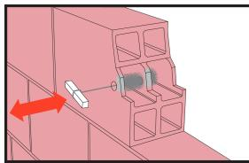
Прочистите отверстие при помощи круглой стальной щётки. Диаметр щётки должен быть больше диаметра просверленного отверстия.
