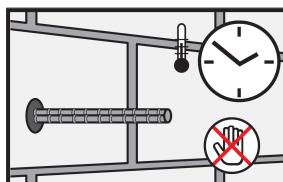
Во время отверждения анкеровочного состава не допускается перемещать или нагружать крепление. Инструменты следует очистить сразу после использования при помощи Sika® Colma Cleaner. Тщательно вымойте руки тёплой водой с мылом.
