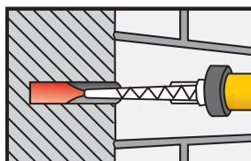
Анкеровочный состав следует нагнетать в отверстие начиная со дна отверстия, при этом медленно извлекая носик. В любом случае не допускайте образования воздушных карманов. Для глубоких отверстий следует использовать удлинительные насадки.
