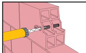
Анкеровочный состав следует нагнетать в сетчатую гильзу начиная со дна отверстия, при этом медленно извлекая носик. В любом случае не допускайте образования воздушных карманов. Для глубоких отверстий следует использовать удлинительные насадки.
