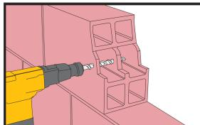
Пробурите отверстие необходимой глубины и диаметра при помощи перфоратора или ударной дрели. Диаметр отверстия должен соответствовать размеру крепёжного элемента и сетчатой гильзы.
