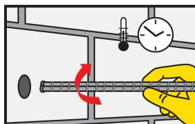
Плавно, с небольшим вращением, вставьте крепёжный элемент в заполненное составом отверстие. При этом анкеровочный состав может частично выйти из отверстия. Крепёжный элемент необходимо установить в течение открытого времени состава.
