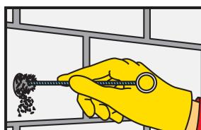
Прочистите отверстие при помощи круглой стальной щётки не менее двух раз. Диаметр щётки должен быть больше диаметра прошурленного отверстия.
