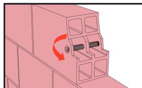
Закройте колпачок сетчатой гильзы, чтобы избежать утечки состава во время погружения крепёжного элемента.
