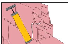
Продуйте отверстия с помощью ручного насоса или компрессора. Продувку необходимо выполнять со дна отверстия! Важно: использовать безмасляные компрессоры.
