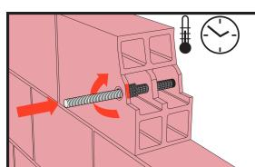
Плавно, с небольшим вращением, вставьте крепёжный элемент в заполненную составом сетчатую гильзу. При этом анкеровочный состав может частично выйти из отверстия. Крепёжный элемент необходимо установить в течение открытого времени состава.
